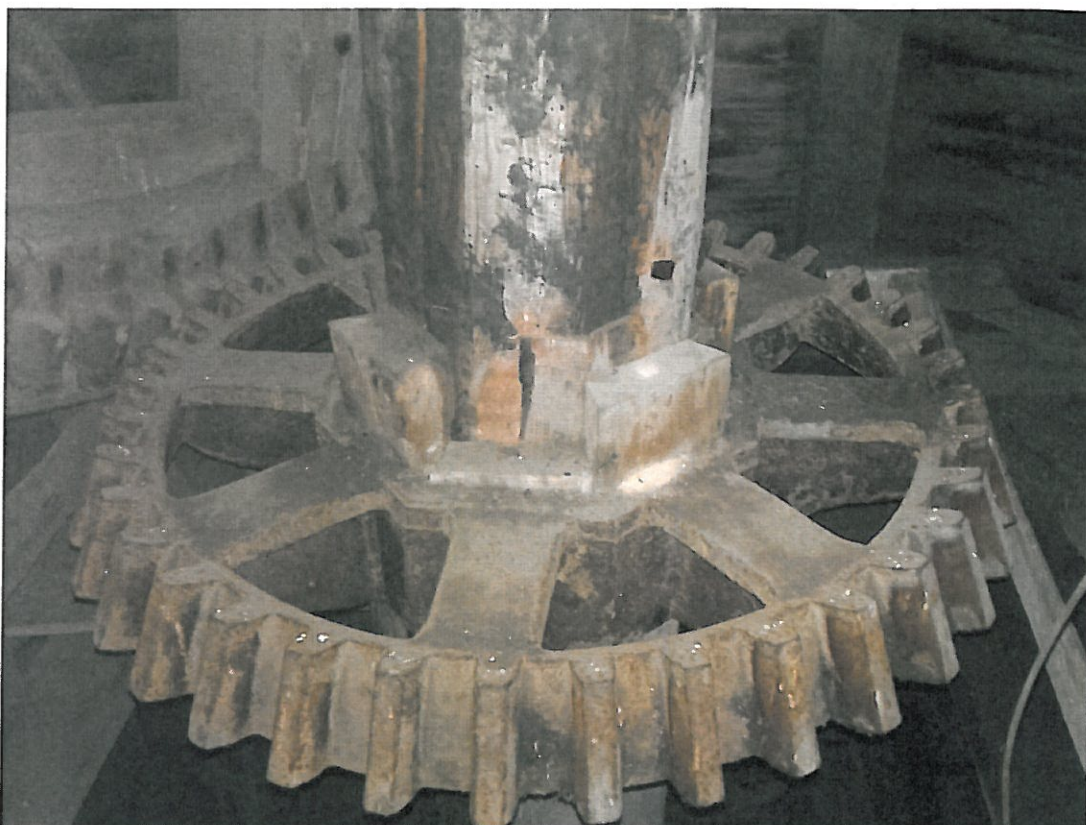
Fot. 20: Przekładnia stalowa ( czapa wiatraka )
